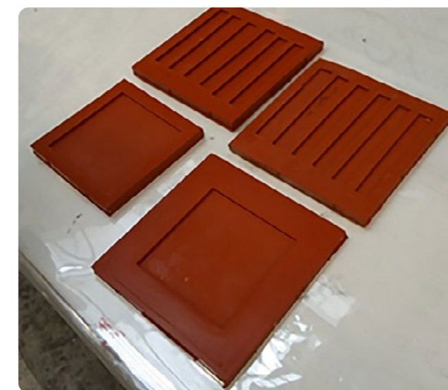
△ 2. ábra: Gélbevonatok öntéséhez használt szilikon szerszámok
