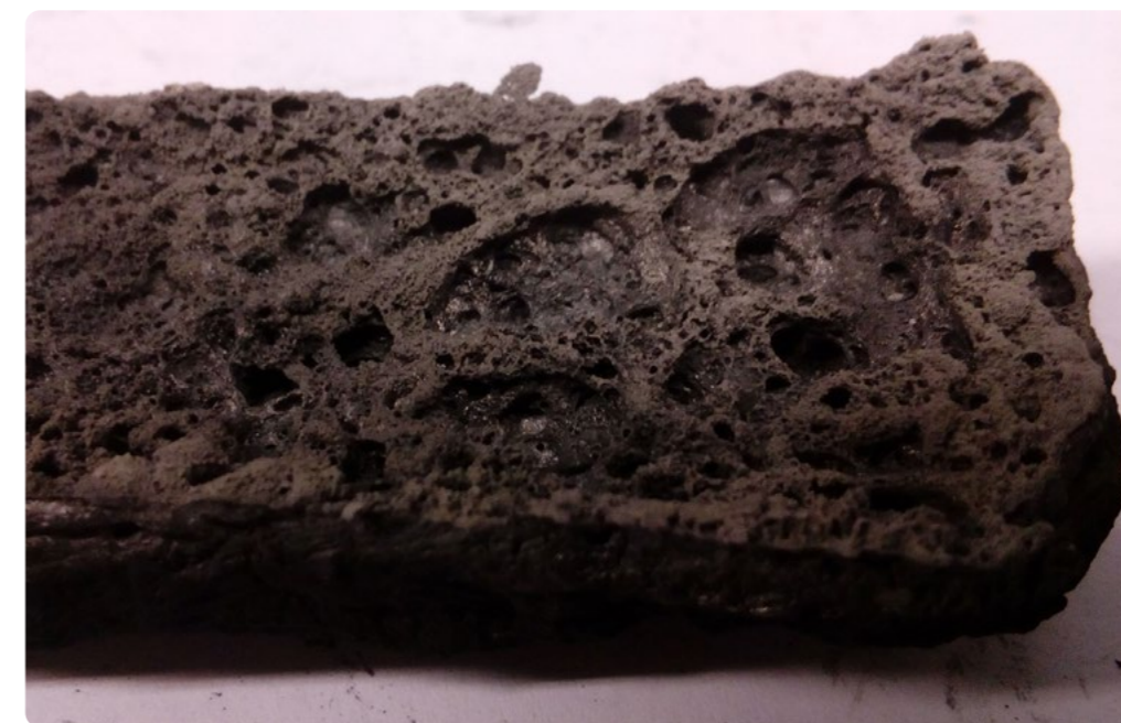
8. ábra: SG715 15%P APP bevonattal ellátott biztonsági öv csúszka mintadarab maradványának habszerkezete a kalorimetriai vizsgálat után
